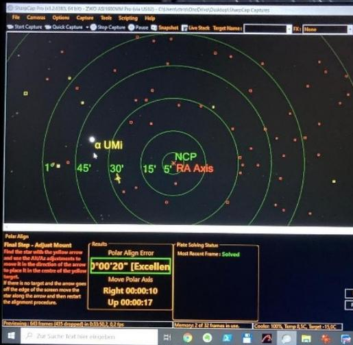
Nach einigen „gefühlvollen“ Drehungen an den massiven M14 Feingewindeschrauben an der Polhöhenwiege, welche die ganze mehrere hundert Kilo schwere Konstruktion mikrometerweise in Azimuth und Deklination bewegen, konnte ein Einnordungsfehler von 20 Bogensekunden erreicht werden.
