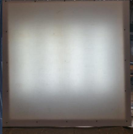
Zunächst haben wir uns der Flatfieldbox gewidmet. Die bestehende Box bestand aus weißen Plexiglasscheiben 1 m x 1 m auf einem stabilen Holzrahmen, welche von vier Leuchtstofflampen aus etwa 50 cm Entfernung angestrahlt wurden. Durch den relativ hohen Abstand zwischen Lampen und Streufläche entstand eine sehr gleichmäßig helle Fläche.
