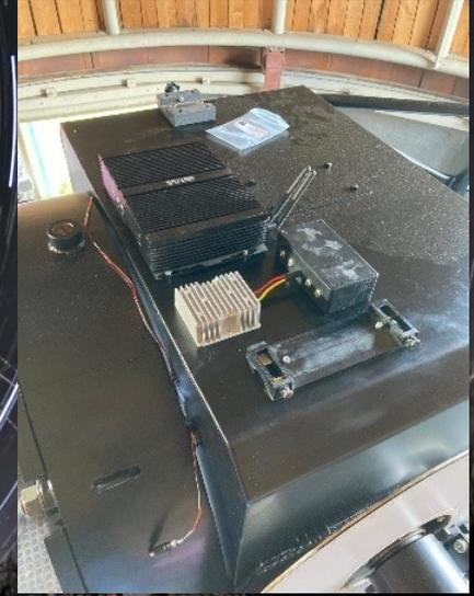
Das Teleskop ist jetzt elektromechanisch fertig. Es folgen umfangreiche Justierarbeiten der Feinmechanik und Soft- und Hardwaretests von der Nachführelektronik des Teleskops (FS2) über die Kuppelantriebe die Fokussierung bis hin zum Öffnen und Schließen der Staubschutzklappen.
